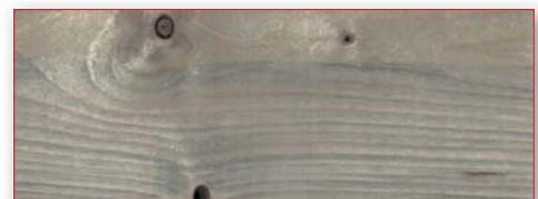
Abb. 5: Erkennung von Blaufäule mit der eingebauten Farbkamera
