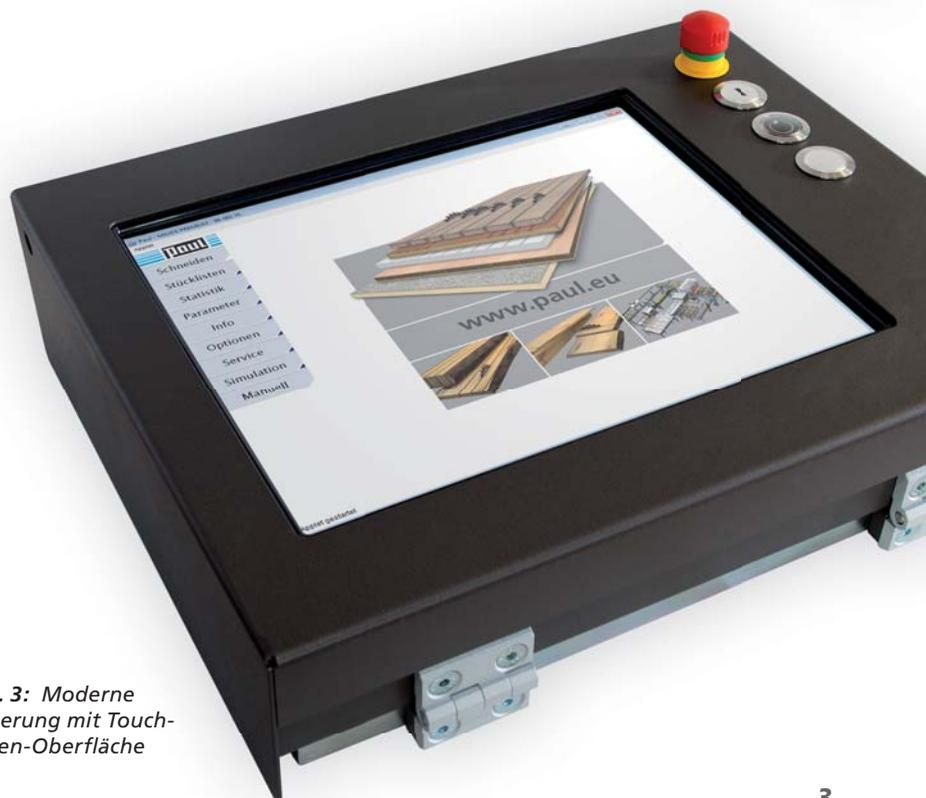
**Abb. 3:** Moderne Steuerung mit Touch-Screen-Oberfläche
