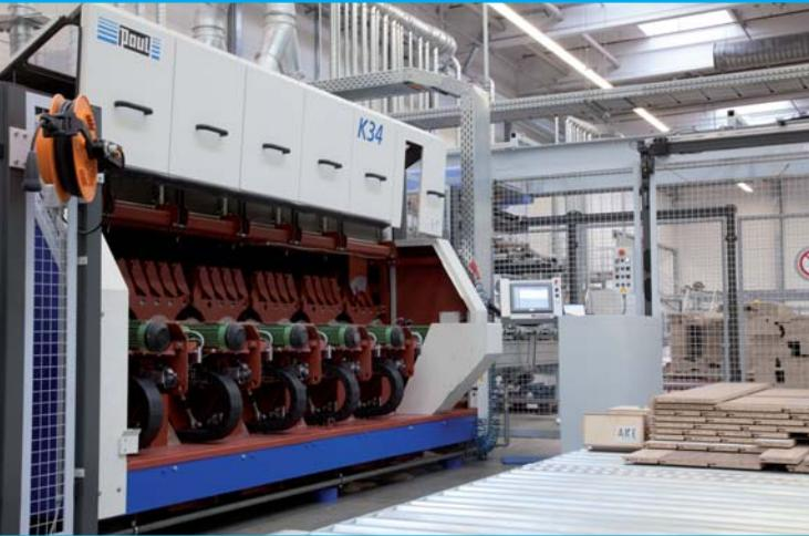
Abb. 7: K34M mit 1800 mm Durchgangsbreite zum Auftrennen von Span- und MDF-Platten im Einsatz.
