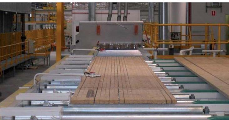
Die höhenverstellbare Sägewelle gewährleistet eine optimierte Schnittqualität und kann von nur einem Bediener innerhalb kürzester Zeit gewechselt werden. Dies minimiert Rüstzeiten und steigert die Verfügbarkeit der Maschine wesentlich.
