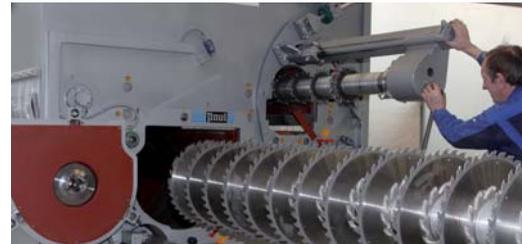
Abb. 6: Einfacher Wechsel der Sägewellen unten und oben.
