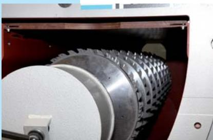
Abb. 4: Die Sägewelle ist unter dem Einlege-tisch angebracht.
