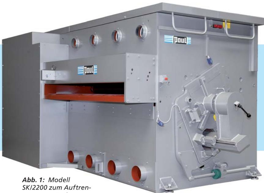
Abb. 1: Modell SKI2200 zum Auftrennen von LVL-Platten.
