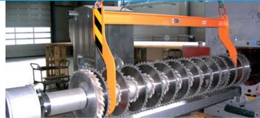
Abb. 5: Spezieller Kranhaken zum Transport der schweren Sägewelle.
