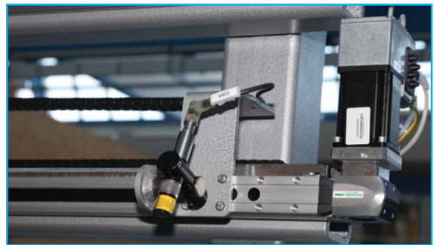
Abb. 12: Linienlaser zeigen die Positionen der Sägeblätter
