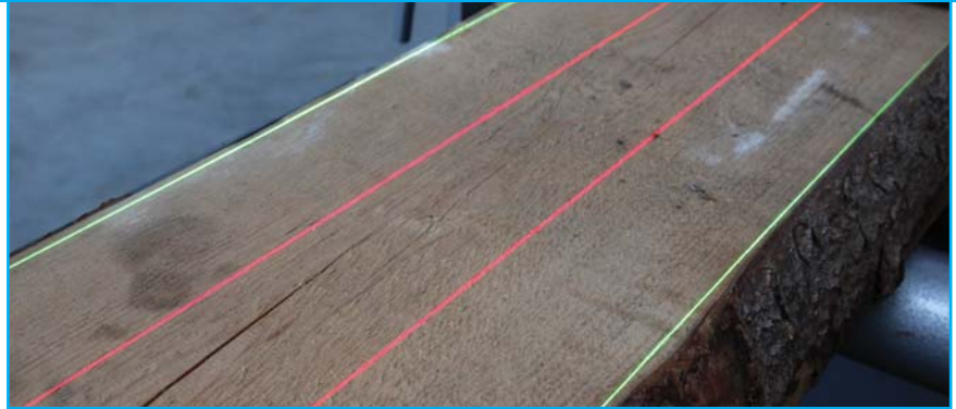
Abb. 16: Linienlaser zur leichteren Ausrichtung der Werkstücke
