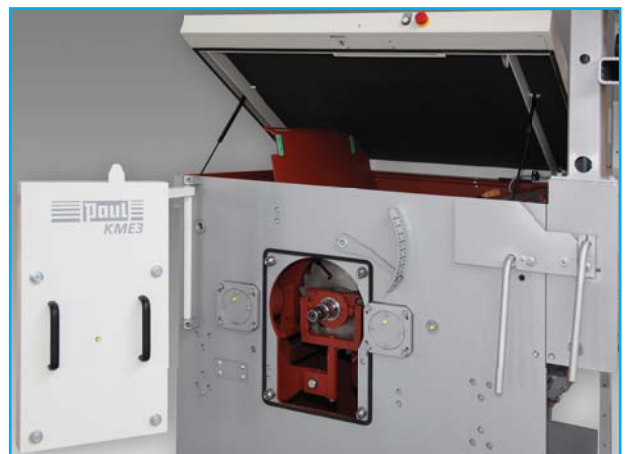
Abb. 13: KME3 mit geöffneter Haube und geöffnetem Vorderlagerdeckel
