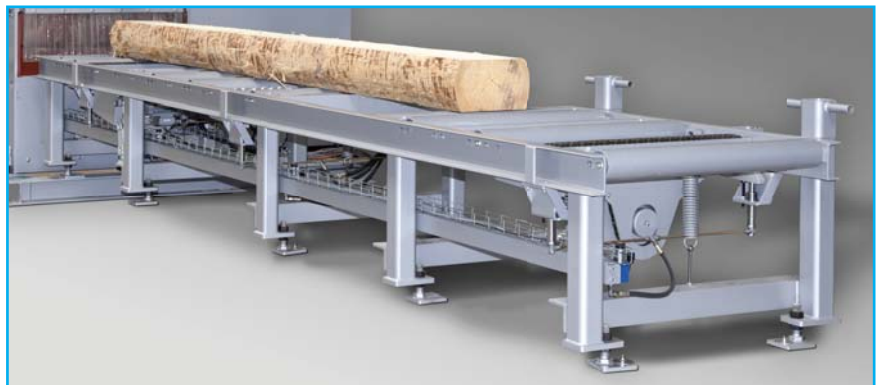
Abb. 18: Komfortabler Ausrichttisch mit manueller Beschickung
