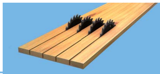
Abb. 25: Auftrennen besäumter Brettware in der Auftrennkreissäge
