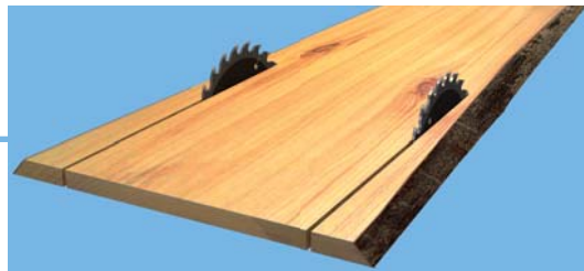
Abb. 23: Besäumen der Brettware in der Besäumkreissäge
