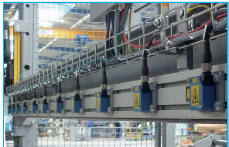
Abb. 4: Die Messköpfe der vollautomatischen Beschickung AB920
