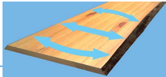
Abb. 22: Vermessen und Ausrichten unbesäumter Brettware in der automatischen Beschickungsanlage
